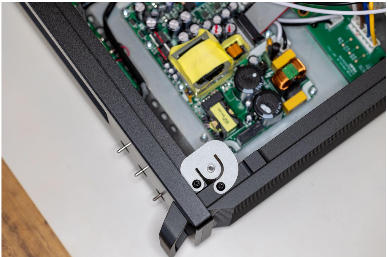
Der Blechbügel in der Ecke ist Teil umfangreicher Anti-Vibrationsmaßnahmen in den TEACs und soll den Deckel vom Rest des Gehäuses entkoppeln. „Semi floating“ nennt der Hersteller das (Foto: F. Borowski)
